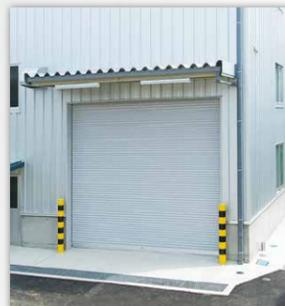
種類 シャッターのスラットは厚さ1.2mm又は1.6mmの垂鉛鉄板、マグサ、ケースおよびレールは厚さ1.2mm~2.3mmの鋼板。
