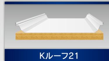
浮き屋根工法の採用で、温度変化による熱伸縮にも追従できるKルーフ21。母屋と屋根パネル間に、断熱スペーサーブロックを設けることで、ヒートブリッジの対策を行い、断熱性能を向上させることも可能です。
