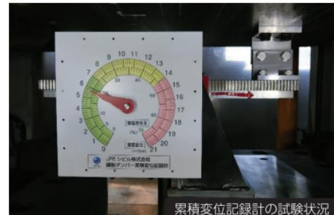
ダンパーの伸縮を指針の一方向に変換して進ませるため、変位量の累積値を表示することができます。(弾性範囲では反応せず、塑性変位のみ記録します。)
