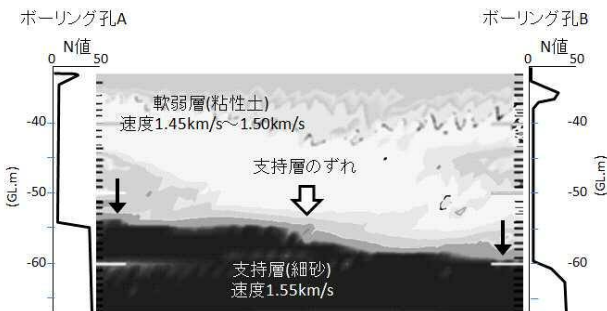
図-2 物流倉庫杭基礎工事における調査結果(速度分布図)
