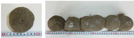
Fig. 5 作成した改良体(左 ケース2, 右 ケース3)
